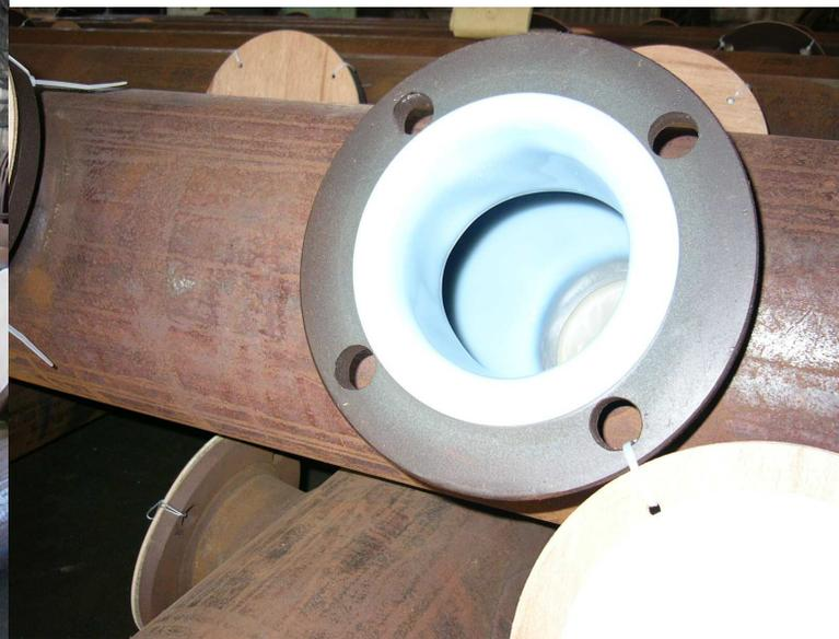
250A配管 皮膜:S-ETFE 膜厚:1.5mm UP
